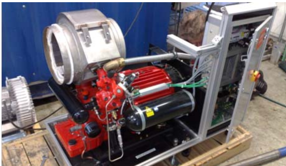
Kuva 1. Solo 161 Stirling- yksikkö josta puuttuu poltin ja palamiskaasujen lämmönvaihdin.
