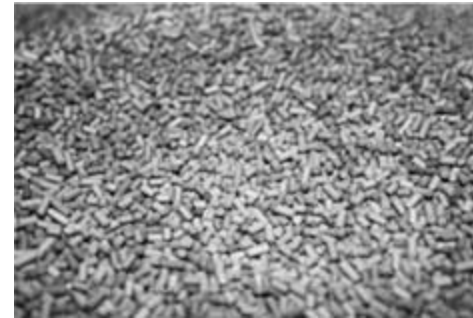
Kuva aktiivihiilestä, jonka avulla vas. puhdistetaan synteetikaasua raskaammista hiilivedyistä
