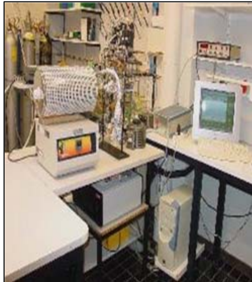
Katalyytin aktiivisuutta mittaava laitteisto
