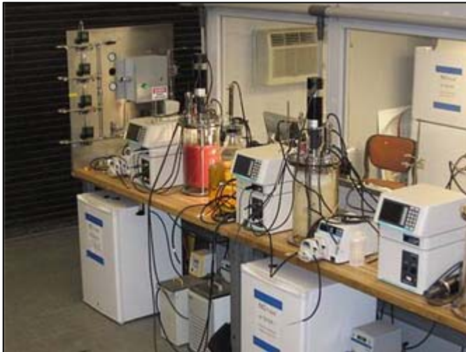
Tutkimuslaitteisto Bio-synteesikaasun fermentointia varten laboratoriomiljöössä Iowa State Universityn laboratoriossa.
