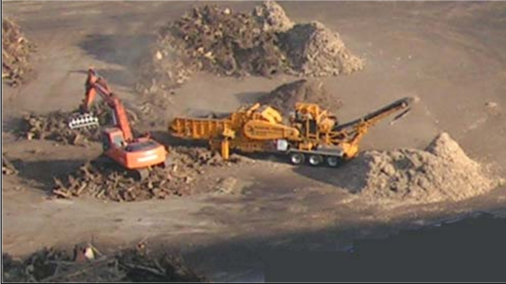
Suuri kantojen murskaamiseen tarkoitettu murskauslaitteisto käytössä Alholmens kraft:n suuressa CHP- laitoksessa Pietarsaaressa.
