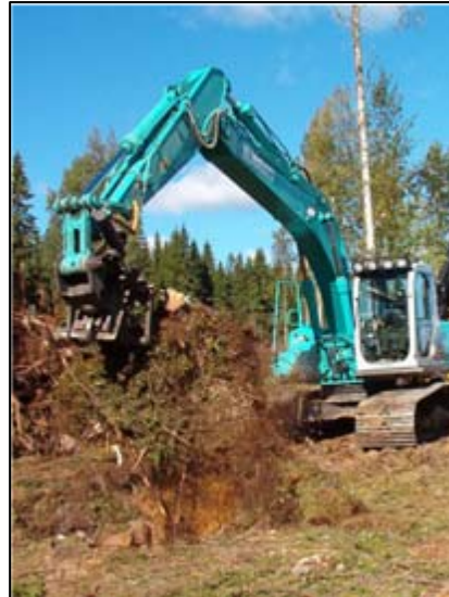
Suuri kantojen murskaamiseen tarkoitettu murskauslaitteisto käytössä Alholmens kraft:n suuressa CHP- laitoksessa Pietarsaaressa.
