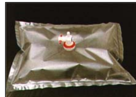
Näytepussi ja näytteenottoventtiili
