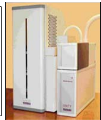
Adsorptioputket analysoidaan TD-GC-MS-laitteistolla.
