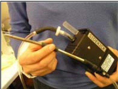
Näytteenottopumppu ja näyteputki (adsorbenttimateriaalina Tenax TA).
