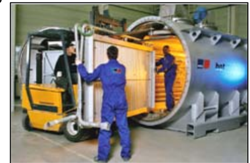
Polttokennopaketin asennus MTU CFC:n tehtaassa Tanskassa.
