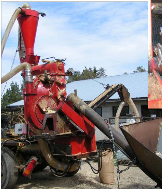
T.v., Inmatning till slagkvarnen med skruv. Fläktransport från kvarnen, via cyklon, till pelletpressen. Färdig pellets förs ut med en bandtransportör till vagn eller storsäck. Ovan, Slagkvarnen som öppnats, rörliga slagor och ett fast 6 mm såll.
