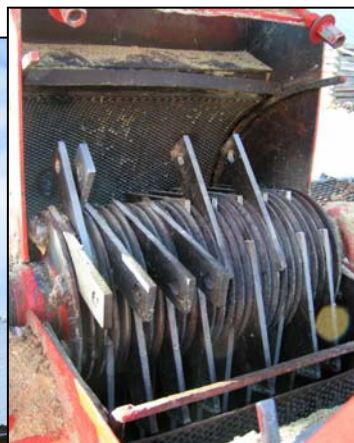
T.v., Inmatning till slagkvarnen med skruv. Fläktransport från kvarnen, via cyklon, till pelletpressen. Färdig pellets förs ut med en bandtransportör till vagn eller storsäck. Ovan, Slagkvarnen som öppnats, rörliga slagor och ett fast 6 mm såll.
